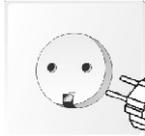
Для обеспечения электробезопасности центрифуга должна быть подключена к сети электропитания с помощью индивидуальной розетки с заземляющим контактом.
